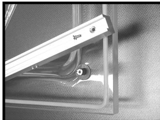
**Nehmen Sie den Silikonhalter aus der Befestigung. Drehen Sie den Schwingungsdämpfer von der Schraube los. Nehmen Sie den Schwingungsdämpfer, den Dichtungsgummi und die Schraube heraus.**
