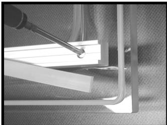
**Entfernen Sie den Silikongummi aus dem Silikonhalter. Drehen Sie die Schrauben an beiden Seiten des Silikonhalters los.**
