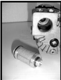
Achten Sie darauf, dass der Dichtungsring beim Herausnehmen nicht im Gehäuse zurückbleibt.
