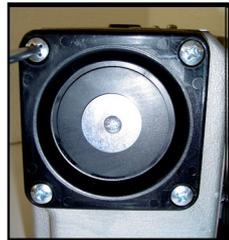
Schrauben Sie den Deckel vom Filtergehäuse
